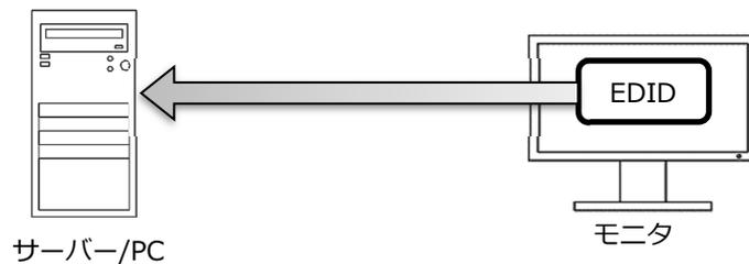
本製品をご利用いただく場合、最初に EDID 情報を読み取るモニターを選択し、モニターの EDID をサーバー/PC に適用するための操作を行っていただく必要があります。
