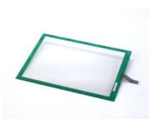
PETフィルム上の透明抵抗膜を位置検出に使用しないで、下部のたわまないガラス基板上の透明抵抗膜のみで直交した座標を検出する方式で、4線式タッチパネルの約10倍の寿命を実現します。また位置検出ごとに電極部電圧のキャリブレーションをおこないます。
