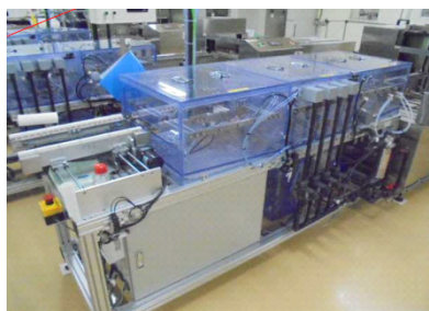
写真1 タッチパネル洗浄における水切りのためのエアの吹き出し口数をガラスサイズに合わせ増減することにより、エア使用量を削減した省エネ（富士通コンポーネント技術開発センター）
